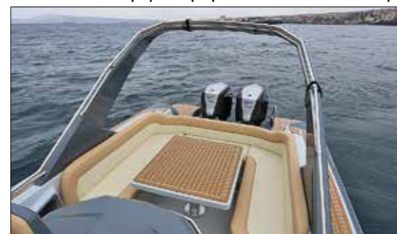
Le salon arrière se transforme tour à tour en coin repas et en généreux bain de soleil grâce à la table qui surgit du plancher de cockpit par simple pression sur un bouton — une option très rare sur un semi-rigide.
