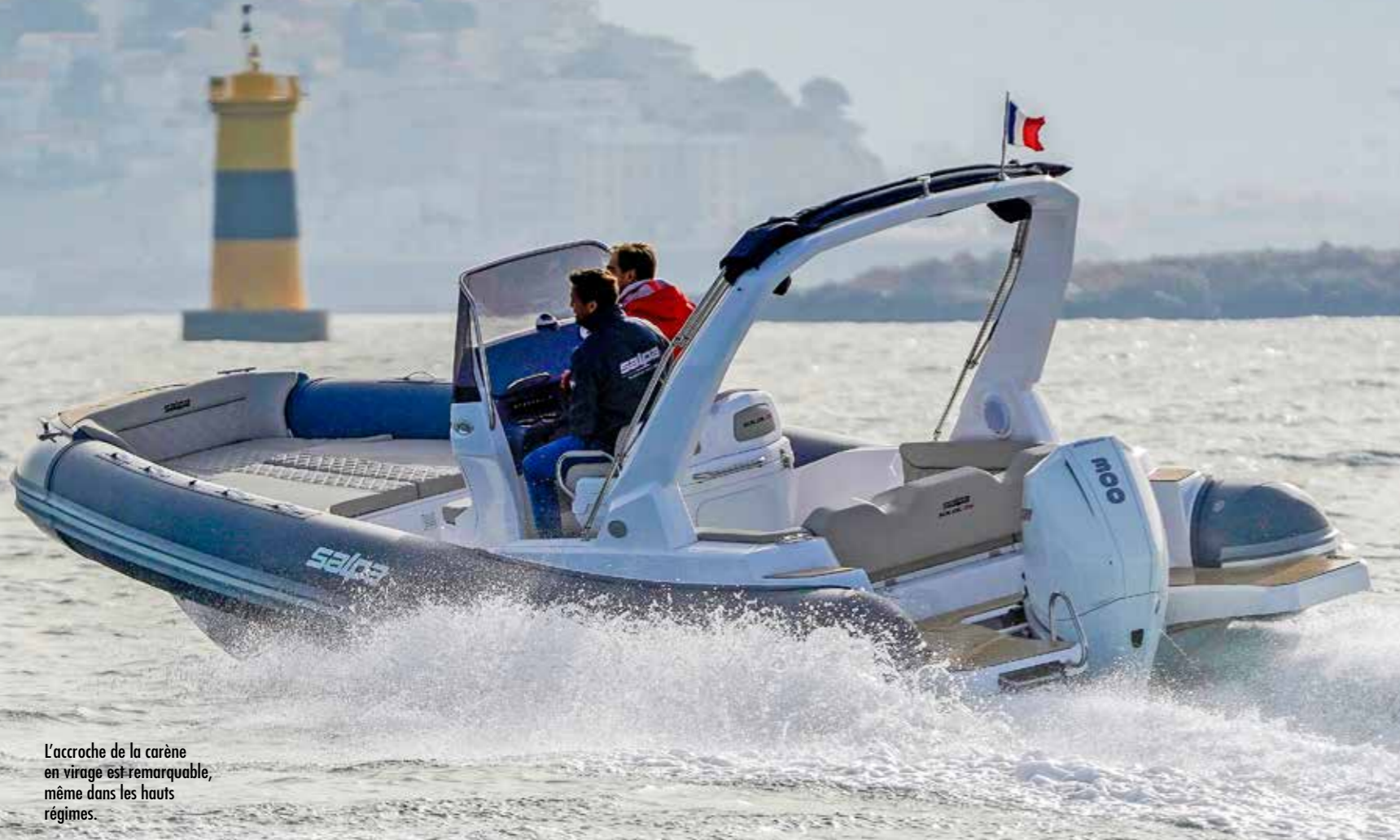
De longues plages de bain enserrant le moteur. Celle à bâbord reçoit une main courante pour faciliter la remontée de l'eau depuis l'échelle de bain.
