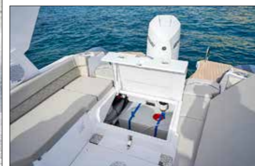
Toutes les assises du carré dissimulent des coffres. Celui situé contre le tableau fait office de soute technique, où prend place le réservoir d'eau douce.
