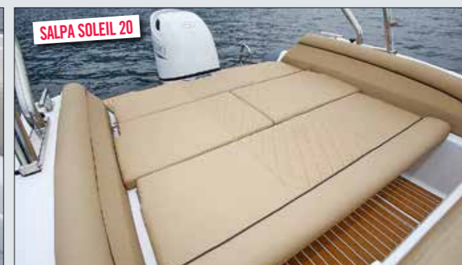
Une fois le dossier de la banquette basculé, l'assise s'avance, laissant un espace libre pour y poser la rallonge, formant ainsi un vaste bain de soleil en trois parties.
